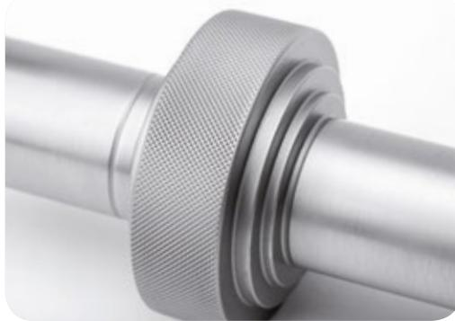
Esa técnica de moleteado solo es utilizable con herramientas de moletar por deformación. Nunca con herramientas de moletar por corte.
